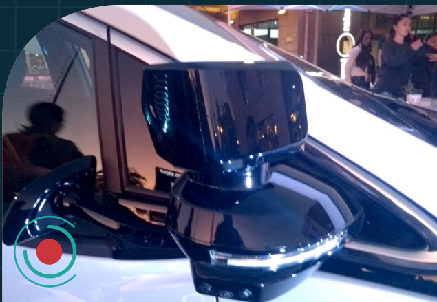
Radar articulado – dispositivo que detecta veículos em movimento a longa distância
