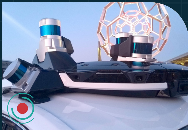
Lidares – sensores a laser de alta precisão, com visão de 360 graus
